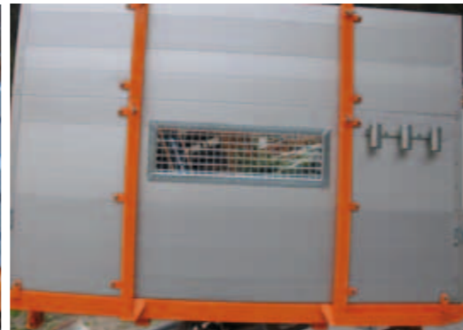
Erhöhte Frontwand mit Sichtfenster und Werkzeughalterungen
