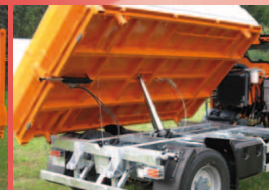
verzinkter Unterrahmen mit Einhängelassen zu Heckkonsole
