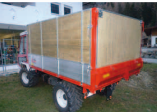
Holzaufsatzwände m verzinkten Stahl-U-Profil eingefasst
