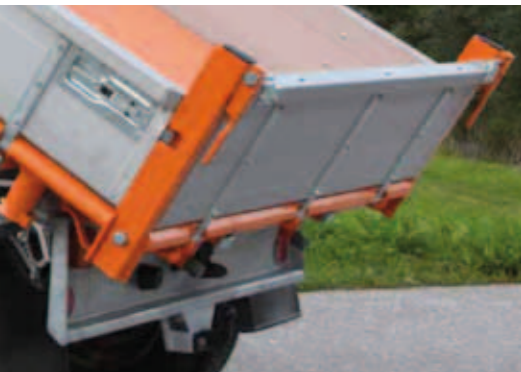
Alubordwände mit Einbauverschlüsse
