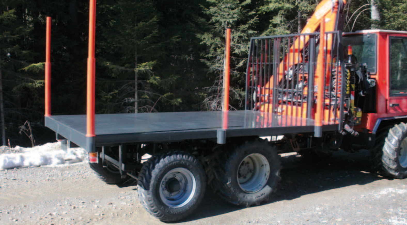
3. Achse Holzaufbau, Frontkran, Rungen eingestellt
