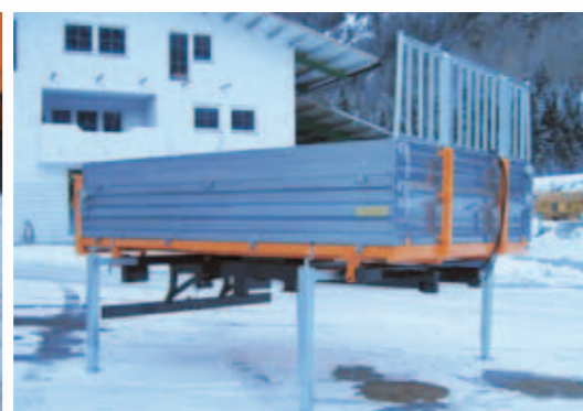
Eisenwände mit Aufsatz Stahlbordwände
