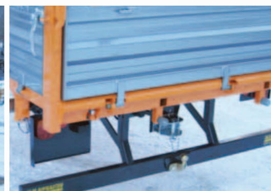
Auffahrerschutz mit Kugelkopfkupplung
