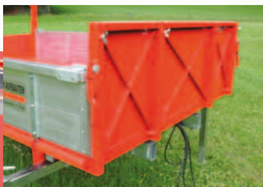
Verstärkte Frontwand mit Formrohraufnahme
