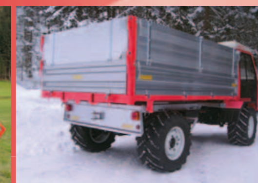
verzinkter Unterrahmen & Aluriffelboden Stahlbordwände komplett verzinkt
