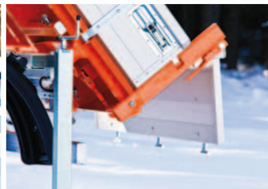
Pendelbordwand hinten Einbauverschlüsse
