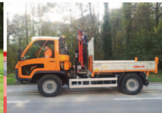
Frontkran-Pritsche, Alu-Boden, Stahlbordwände, komplett verzinkt
