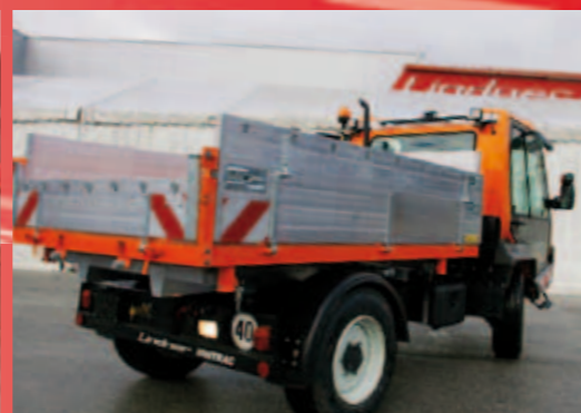
Alu Bordwände mit versenkten Verschlüssen
