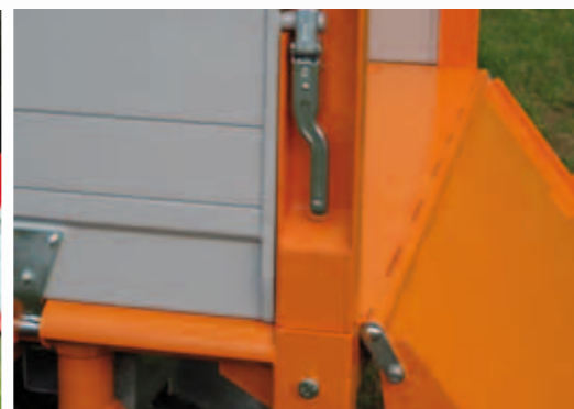
Spezialecksteher aus U-Profilen m. verstärkten Pendelverschlüssen versenkt
