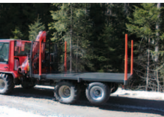
Bei Leerfahrt kann die Achse bis 20cm angehoben werden, optimaler Antrieb an der HA
