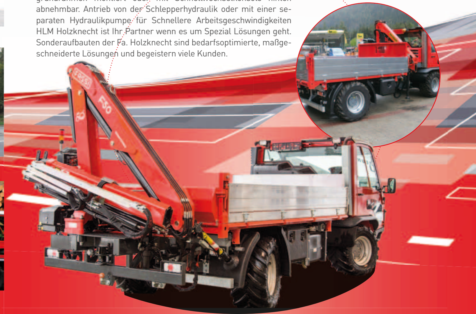
Frontkran-Pritsche, Alu-Boden, Stahlbordwände, komplett verzinkt
