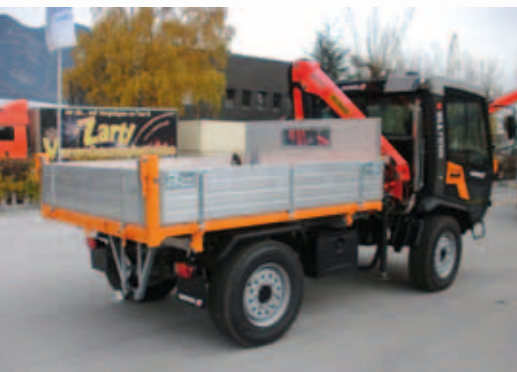
Frontkran, Kipper, Alubordwände, versenkte Verschlüsse
