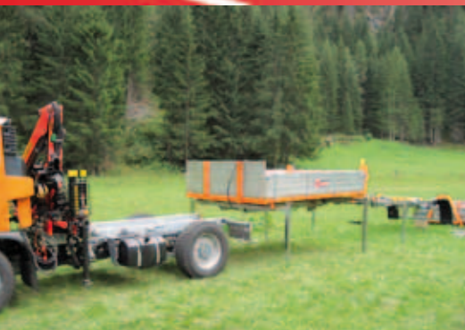
Frontkran mit Rahmen und Dreiseitenkipper
