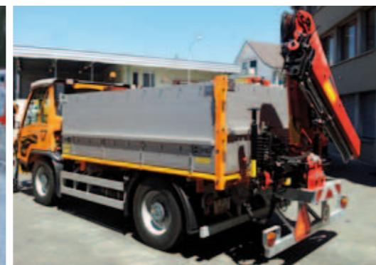
Heckkran SW-Konsole, Alubordwände, Alu-Aufsatz
