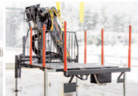
Holz kran mit seperater Pumpe und HY-Tank
