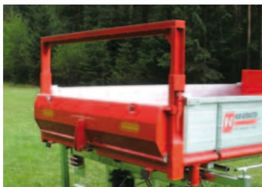
Hydraulische Heckbordwand verstärkt
