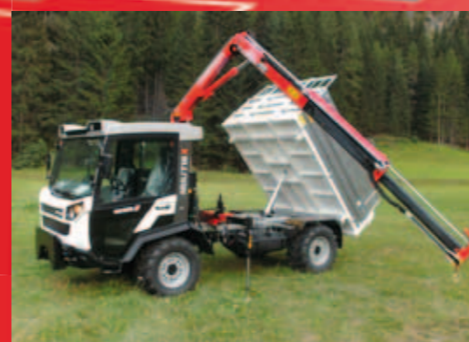
Dreiseitenkipper mit Kranaufbau
