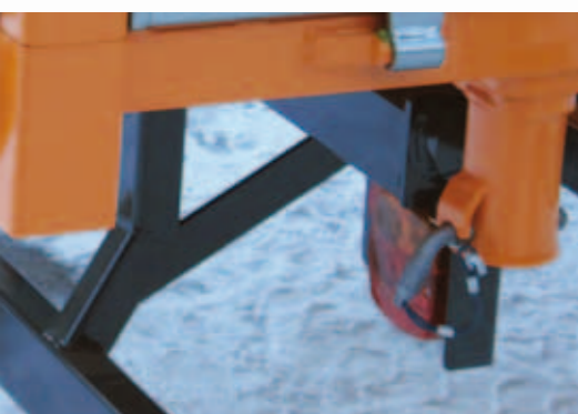
Stark dimensioniertes Kugelkippkager 12t
