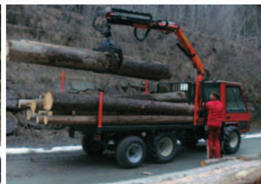
selbstlenkende Nachlaufachse gebremst, hydr. Arretierung
