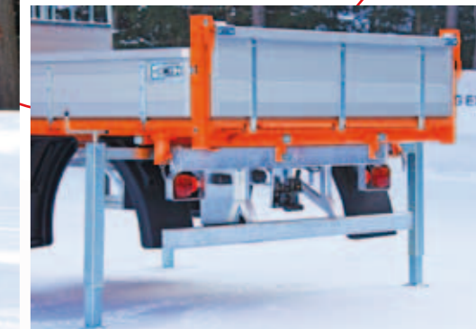
Unterfahrerschutz mit integrierter Beleuchtung und autom. Anhängerkupplung
