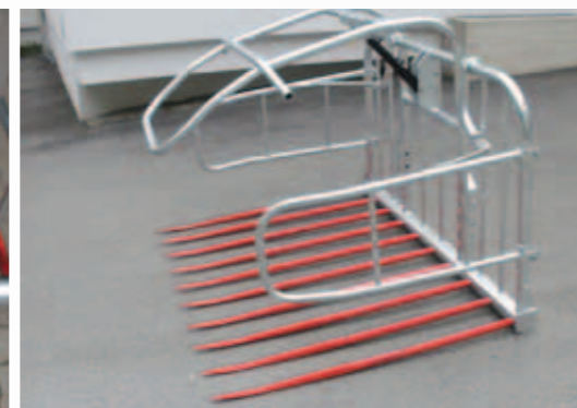
Seitenbügel automatisches Öffnen mit Hauptrahmen
