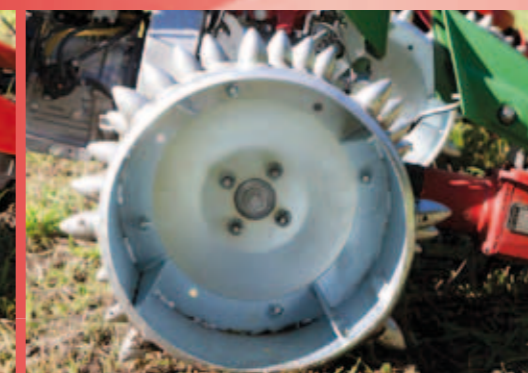
Fixmontage mittels Verschraubung
