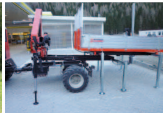
Frontkran mit Wechselrahmen, Kipper mit Alubordwände
