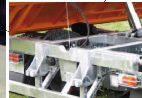
Schnellwechselkonsole Heckkran abnehmbar, komplett verzinkt
