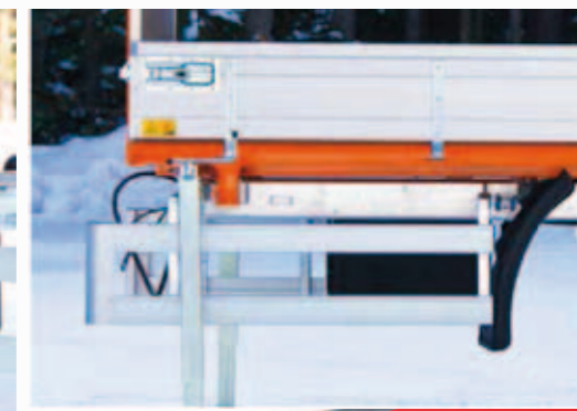
seitlicher Auffahrtschutz mit Aluprofile
