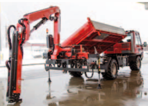
Heckkran abnehmbar mit Schnellwechselkonsole
