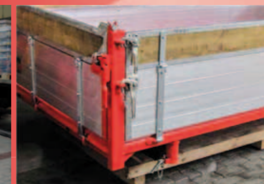
Holzaufsatz mit verzinkter U-Einfassung
