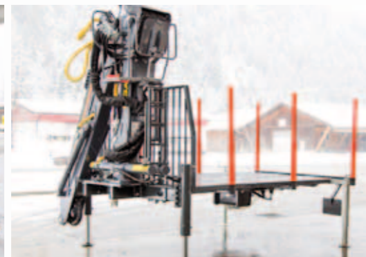
Holz kran mit Rungenaufbau
