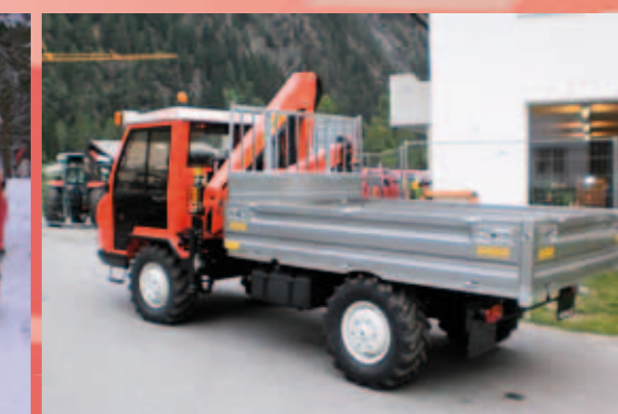
Stahlbordwände verzinkt, Unterrahmen, Unterfahrerschutz mit Beleuchtung, Alu Aufsatz, Pritsche mit Kranaufbau
