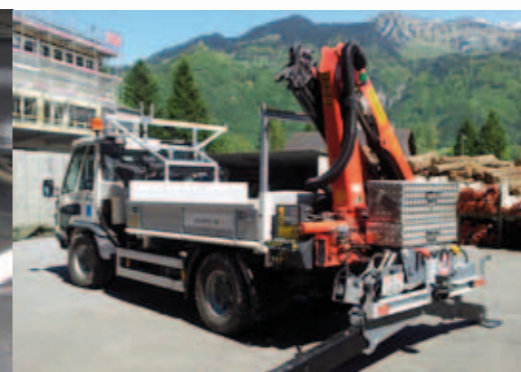
Heckkran mit Spezialabstützung
