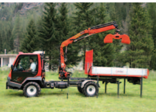
Frontkran m. Wechselrahmen Kipper Aluwände, hydr. Heckwand
