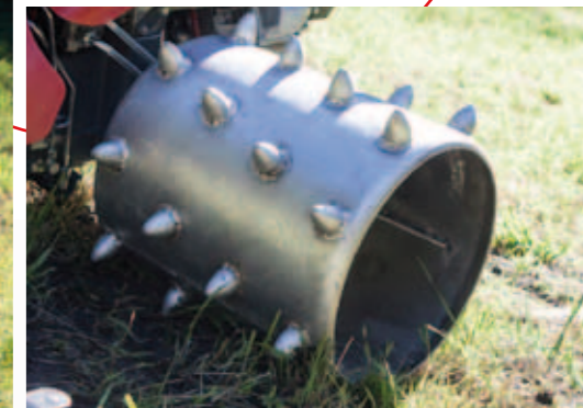
Alu - Stachelräder light massiv, leicht und stabil
