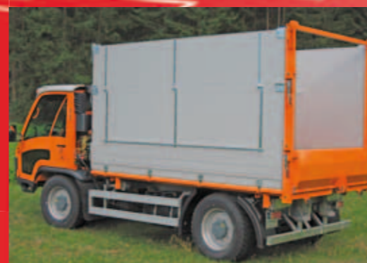
verstärkte Alubordwände BW-40 mit Aluaufsatz geteilt
