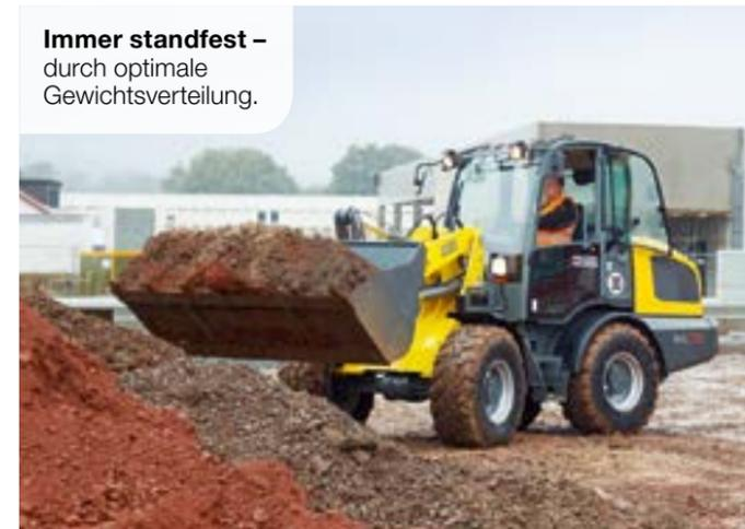
**Mit der 4-in-1-Schaufel** wird Material optimal aufgegriffen und dank proportionaler Steuerung gleichmäßig verteilt.
