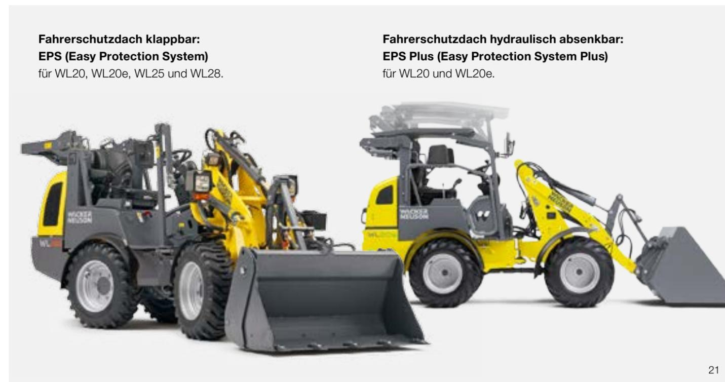
**Fahrerschutzdach klappbar: EPS (Easy Protection System)** für WL20, WL20e, WL25 und WL28.
