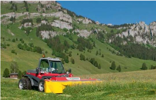
Bergiges Gelände stellt hohe Ansprüche an die Technik. Auf diese Einsatzverhältnisse hat PÖTTINGER bereits 2003 die Entwicklung seiner NOVAALPIN Front-Scheibenmäher abgestimmt. Leichtzügige, robuste und gewichtsreduzierte Maschinen sind das Resultat.
