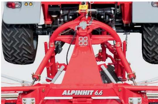
**Der ALPINHIT 6.6 ist ein Leichtgewicht mit sechs Kreiseln. Der Anbaubock ist serienmäßig mit Nachlaufeinrichtung und Dämpfstreben ausgestattet.**
