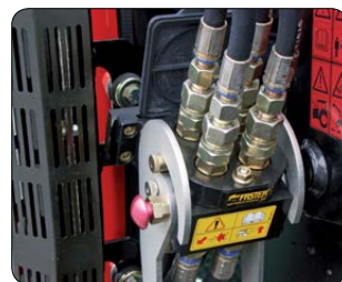
Multischlauchkuppler Schnelles und problemloses Ankuppeln der Hydraulikanschlüsse.
