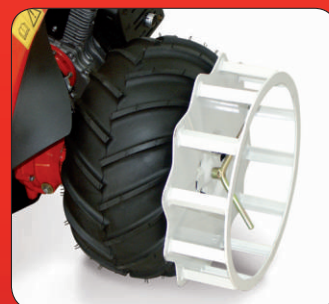
Bereifung 21x11.00-8 mit Gitterrädern zu REFORM 626 D.
