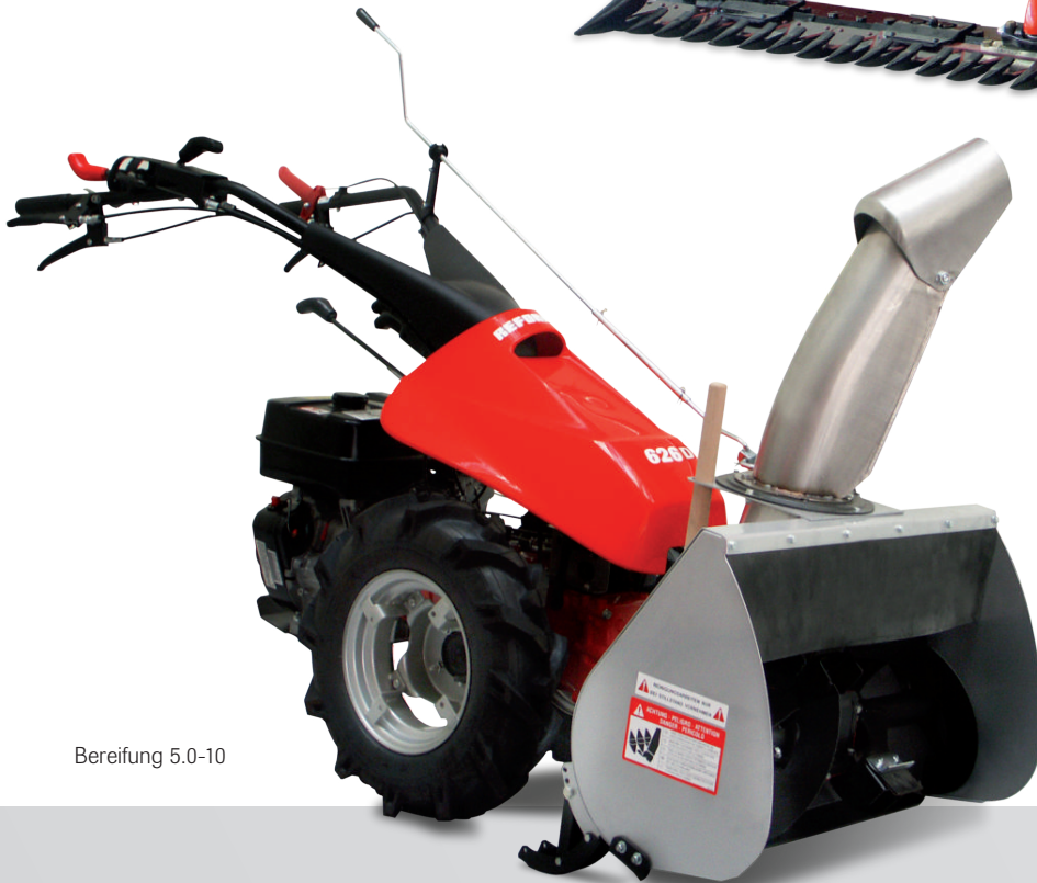
Der Schneefräse mit verstellbarem Auswurfkamin können auch größere Schneemengen nichts anhaben. Option: Schneeketten zur Bereifung 5.0-10.
