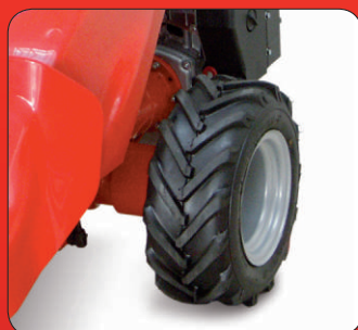
Bereifung 16x6.50-8 zu REFORM 617 D und 626.
