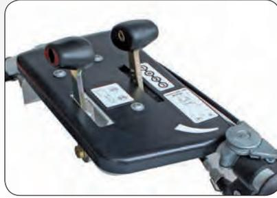
Das **3-Gang Getriebe** bietet dem Anwender gleich mehrere Vorteile. Drei optimal abgestufte Arbeitsgänge ermöglichen die perfekte Anpassung an unterschiedlichste Gelände- und Futterverhältnisse. Auch längere Anfahrtswege zum Einsatzort können schneller und komfortabler bewältigt werden.
