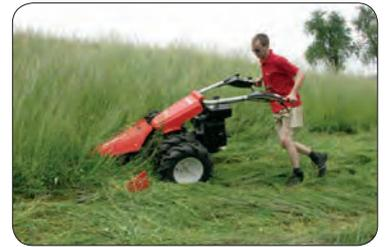
**M3 L** Der besonders Komfortable mit **Einzelrad-Lenkbremsekupplungen** für feinfühliges Manövrieren und Wenden auf Böschungen und in der Landschaftspflege.
