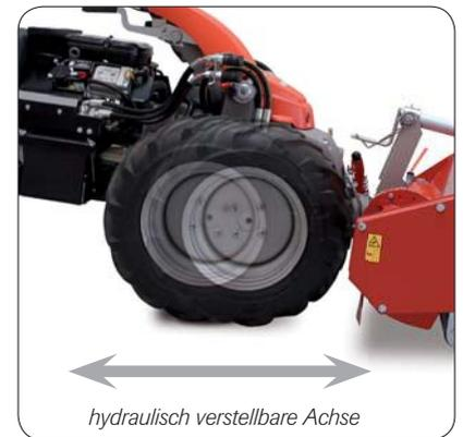
Dank elektrohydraulischer **Verstellung der Antriebsachse** (auch während der Fahrt möglich) gehört kraftraubendes Ballastieren der Vergangenheit an. Schnelle Einsatzwechsel und die dazu erforderliche Schwerpunktanpassung erfolgen bequem per Tastendruck.
