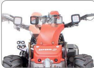
Der Lenkholzm des RM25 ist serienmäßig **seitlich verstellbar**. Einsätze entlang Hecken oder das Ausmähen neben Zäunen sind somit kein Problem. Auch Wartungsarbeiten und Tankvorgänge sind dadurch mühelos durchführbar
