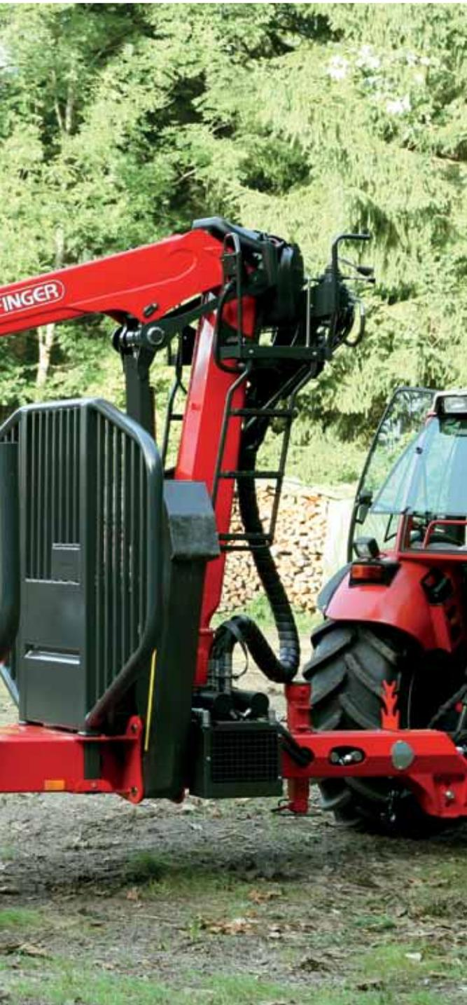
Die beiden größeren Forstanhänger von STEPA sind mit 17" bzw. 22,5" Bereifung ausgestattet. Ein größerer Rungenkorb mit stärkerem Frontgitter ermöglichen mehr Ladevolumen. Dazu passend gibt es diese Forstanhänger auch mit einem größeren hydraulischen Hilfsantrieb, hydraulisch verstellbarer Achse und gefedertem Achsaggregat.
