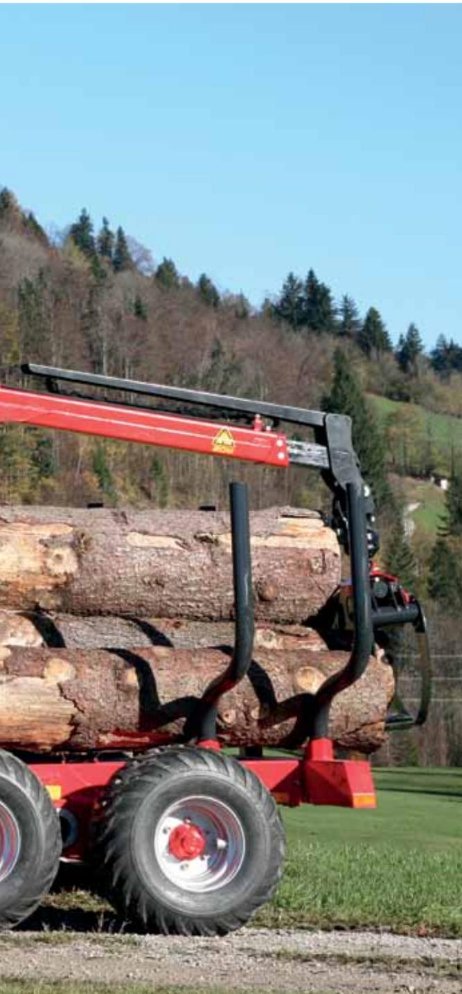
Die Forstanhänger der L-Klasse von STEPA wurden als erste Rückewägen mit integriertem Forstkran entwickelt. Der überzeugend niedrige Schwerpunkt und die serienmäßig patentierte Knickdeichsel mit einem Schwenkbereich von +/-40° mit integrierter Hydraulikpumpe sind wesentliche Merkmale dieser Baureihe. Zudem ist diese Klasse serienmäßig mit LED-Leuchten ausgestattet und mit einem 900mm ausziehbaren Rahmen erhältlich.
