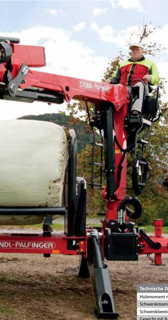
Durch das innovative Doppelteleskopsystem sind alle Schläuche bis zum Greifer im Armsystem geschützt verbaut. Damit ist die Gefahr einer Beschädigung der Schläuche durch Äste minimiert. Trotzdem kann mit wenigen Handgriffen ein defekter Schlauch erneuert werden.
