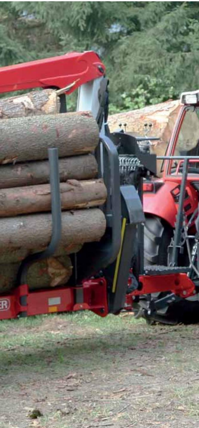
Die Forstanhänger der Compact-Klasse von STEPA bestechen durch ihr geringes Eigengewicht. Sie eignen sich besonders für kleine Zugmaschinen mit wenig Leistung. FHC Forstanhänger verfügen über einen massiven Doppelrohrrahmen in Stahlqualität S500 und einer Knickdeichsel mit großem Schwenkbereich von +/-40°.
